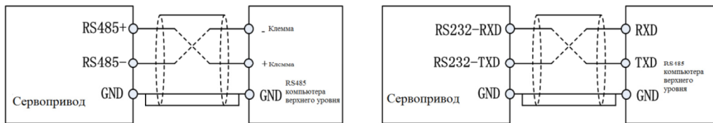
Рис. 3-19 Схема подключения коммуникационного разъема
