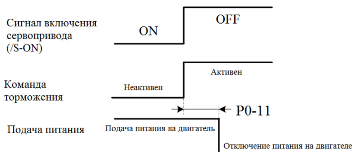
Рис. 3-22 Последовательность торможения с включенным сервоприводом
